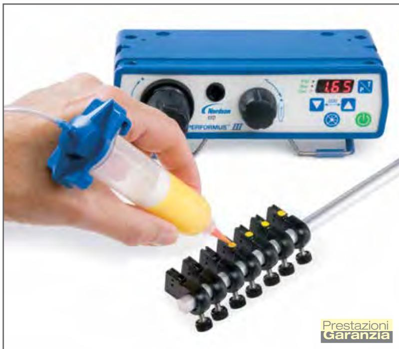
Il Performus III è dotato di regolatore di pressione 0-7 bar (0-100 psi) in grado di controllare tutti i tipi di fluido.
