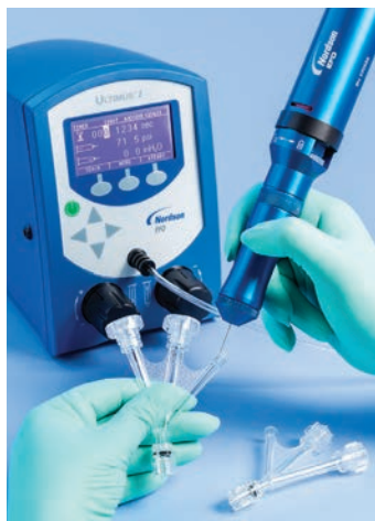
Dosatura di adesivi su componenti medici con sistema HPx™.
