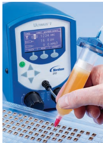
Dosatura di flussante su componenti elettronici.
